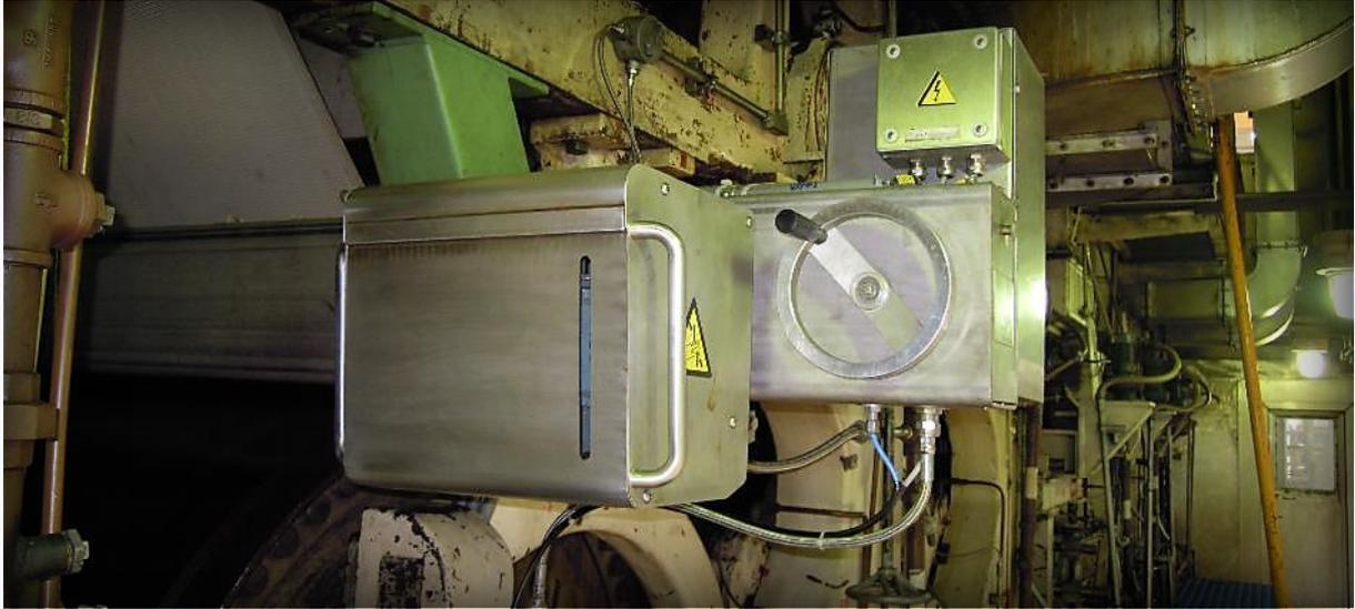
*Сводная отсечка PCF Tail Cutter для сушильной части с вращающимся ножом в работе*
