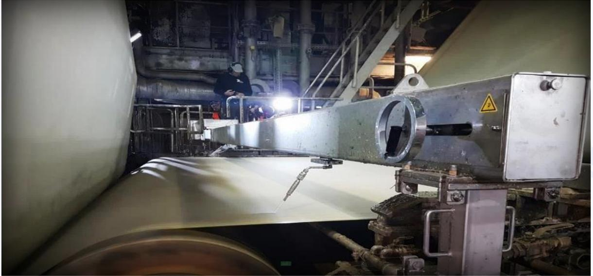
*Сводная отсечка PCF Tail Cutter для мокрой части в работе*
