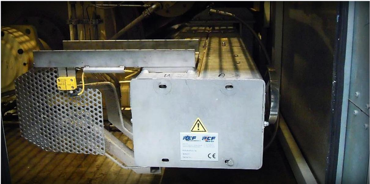
*Сводная и кромочная отсекки PCF Tail & Deckle Cutter для сушильной части, с водяными форсунками ВД в работе*
