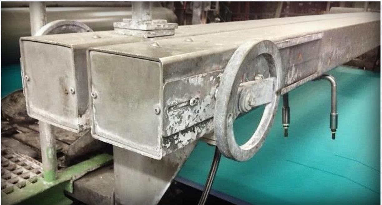
*Сводная и кромочная отсечка PCF Tail & Deckle Cutter для мокрой части в работе*
