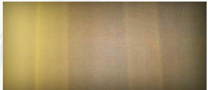
*Очистка сукна осциллирующим спрыском часто приводит к появлению полос*
